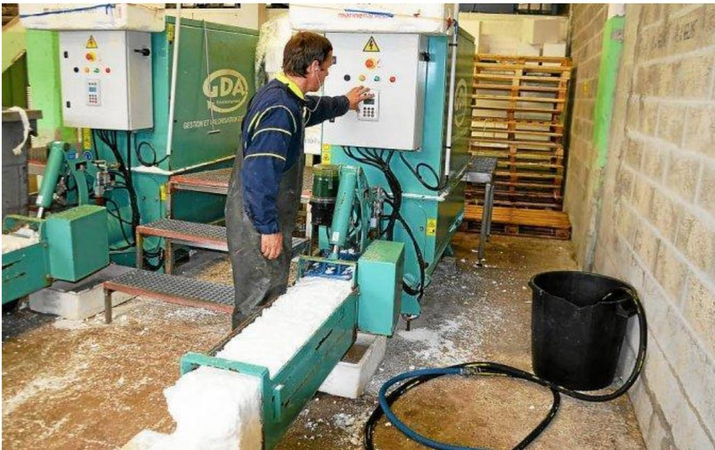
Figure 36 : deux compacteurs à polystyrène expansé installés au port de Lorient (source : letelegramme.fr ; 2016)
